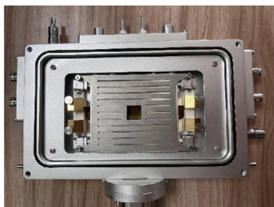
■ 定制原位电池冷热台, 不同温度下充放电时的显微观测, 兼容表面和截面观测
