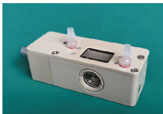
■ 定制原位电池冷热台, 不同温度下充放电时的显微观测, 兼容表面和截面观测
