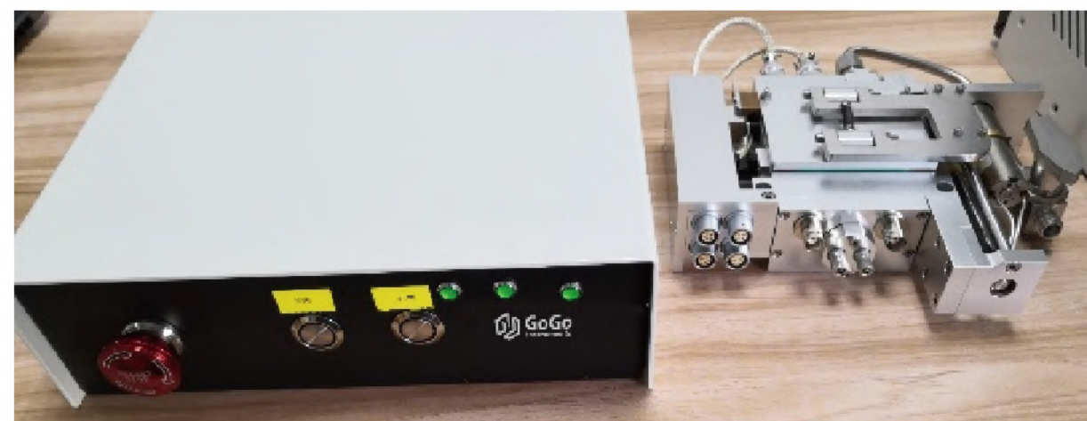
■ 定制SEM变温真空转移盒, -100°C~100°C, 支持在手套箱内装载样品, 保护气氛下转移到SEM内进行变温测试
