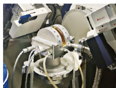
■ XRD原位冷热台适配理学X射线衍射仪
