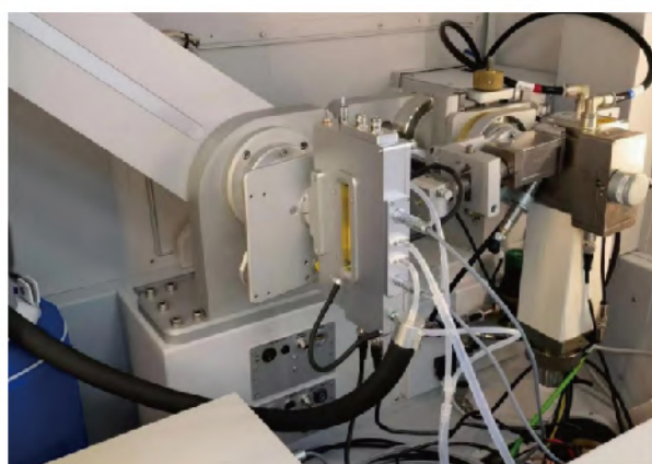
■ 适配赛默飞XRD, 用于软包电池变温充放电时的XRD研究
