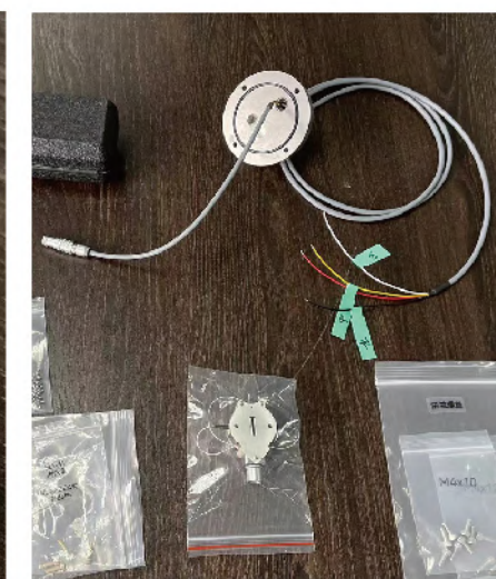
■ 定制SEM变温真空转移盒, -100°C~100°C, 支持在手套箱内装载样品, 保护气氛下转移到SEM内进行变温测试
