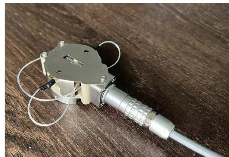
■ 定制SEM变温真空转移盒, -100°C~100°C, 支持在手套箱内装载样品, 保护气氛下转移到SEM内进行变温测试
