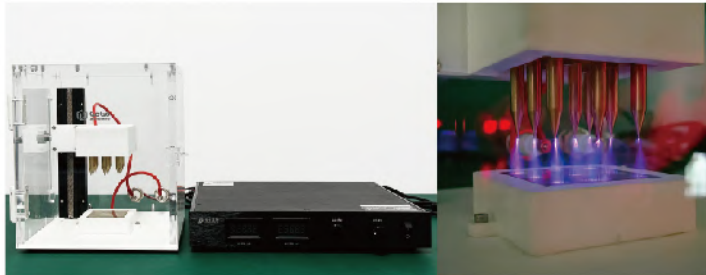
30kV高压极化装置
