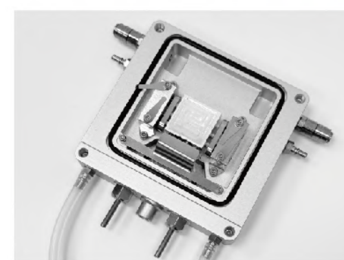
■ XRD超高温热台, 适配布鲁克D8系列, 测试68%Pt/C
