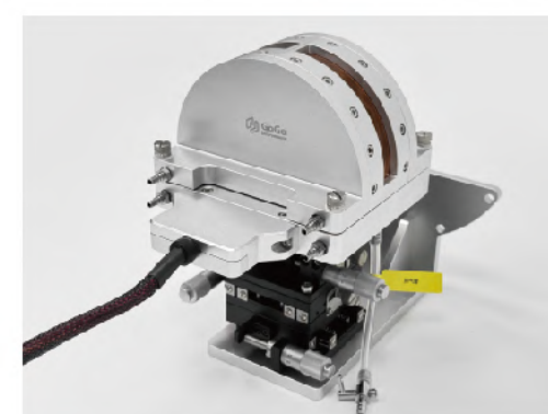
■ XRD超高温热台, 适配布鲁克D8系列, 测试68%Pt/C
