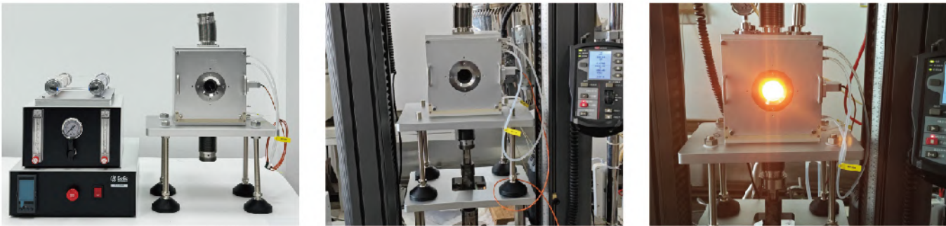
定制1000°C万能试验机超高温红外聚焦加热系统
