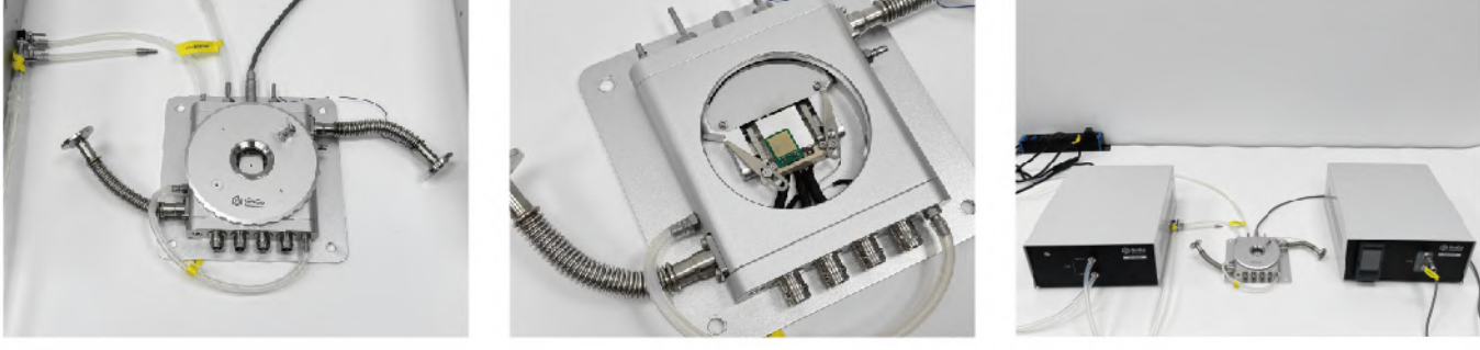
定制排针式电学冷热台, 将探针替换为排针方式, 操作便捷, 漏电流 \leq 100\text{fA}
