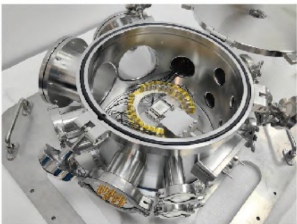
定制外部调节探针冷热台,耦合光、电、温度等多场原位测试
