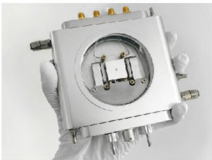
定制SMA接口探针冷热台 (接线柱方案)
