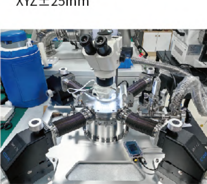
定制外部调节探针冷热台, XYZ±25mm
