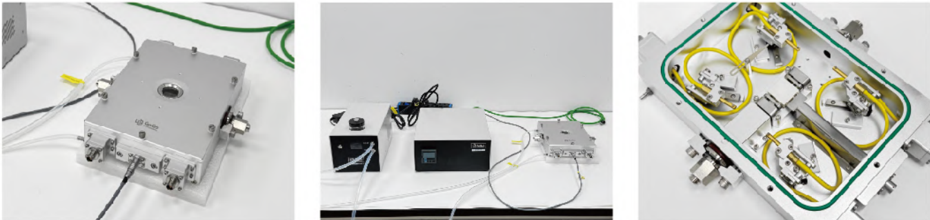
定制探针热台, RT~600℃, 漏电流 < 50\text{fA}
