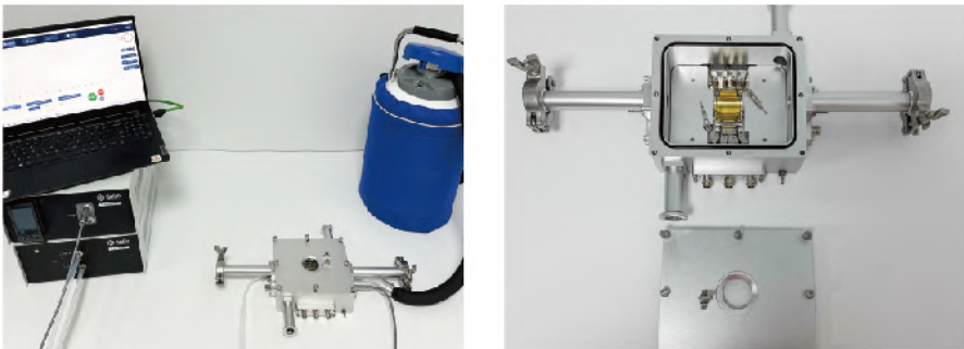
定制真空探针台,用于光纤样品研究
