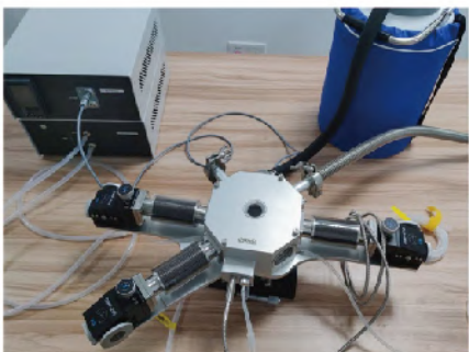
定制外部调节探针冷热台,耦合光、电、温度等多场原位测试
