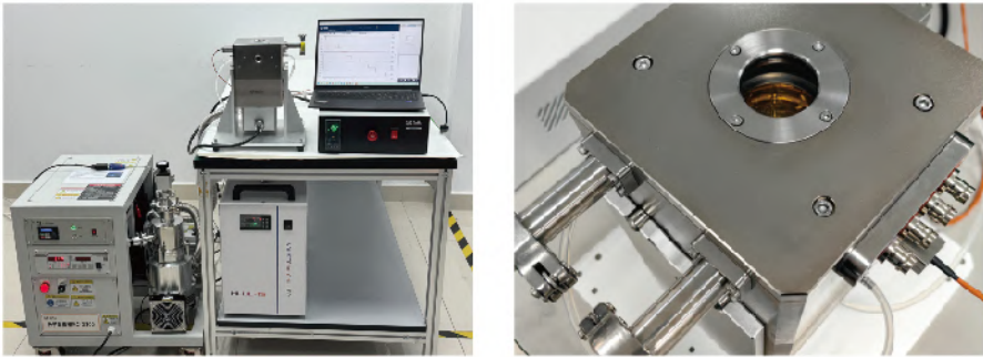
定制超高温红外聚焦加热电学测试系统
