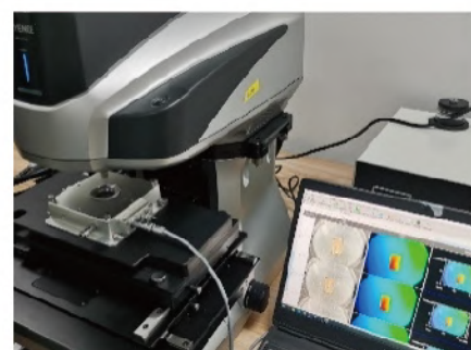
适配基恩士3D显微镜 测试样品3D变形
