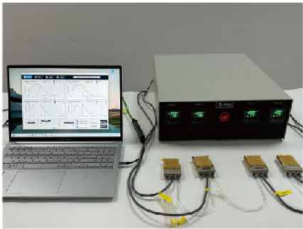
定制0~5bar高压台,-60℃~600℃, 电池粉末研究
