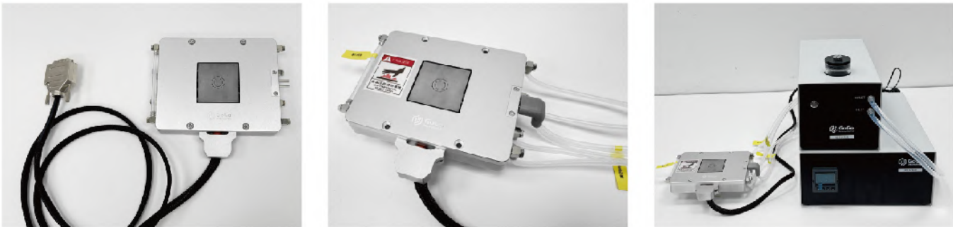
高精度控温热台, RT~600°C
