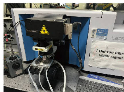
适配horiba拉曼衍射仪(样品石墨烯)
