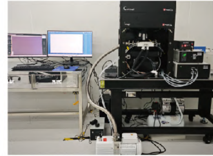
定制-190℃~150℃, 4英寸载样台光学冷热台, 晶圆mapping测试
