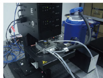
适配OLYMPUS共聚焦显微镜 多孔氧化镍变温拉曼测试
